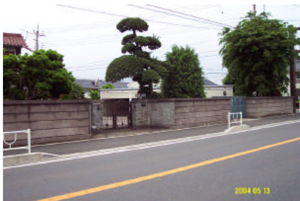
▲ フラット歩道の副作用＝車が乗り込めること。 合理性を欠いた切り下げ延長箇所が目立つ
